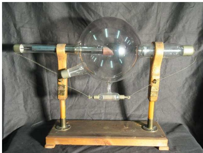
Abbildung 32: Röntgenröhre (außer Betrieb)
