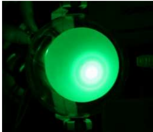
Abbildung 30: Ringförmiges Interferenzmuster, welches durch die Beugung der Elektronen zustande kommt
