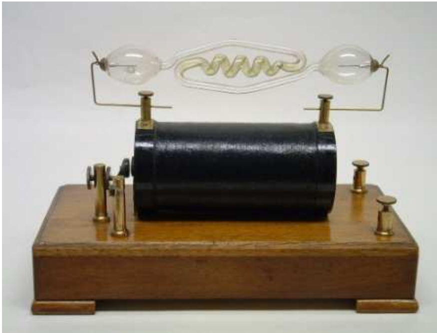
Abbildung 3: Funkeninduktor mit eingespannter Gasentladungsröhre © cristie.com ( http://www.crtsite.com/page8.html )
