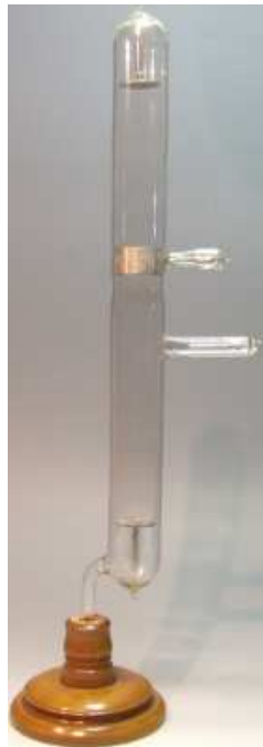
Abbildung 20: links: Kanalstrahlröhre nach Wien (außer Betrieb) rechts: Kanalstrahlen
