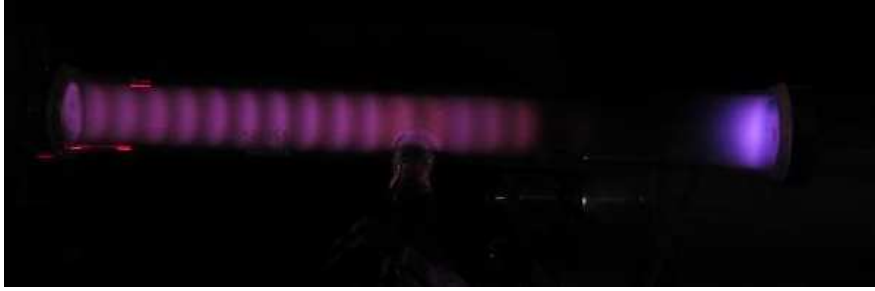
Abbildung 24: Gasentladungsröhre mit angeschlossener Vakuumpumpe © http://www.biosensor-physik.de/biosensor/gasentladung.htm
